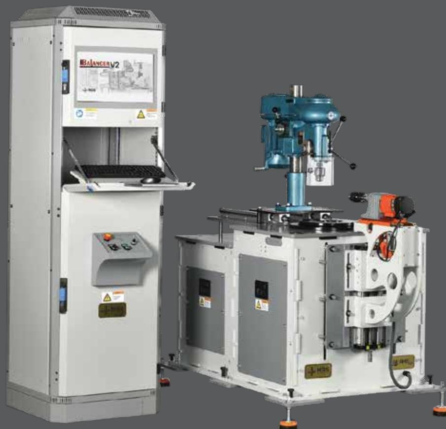
Вертикальный балансировочный станок серии V-IVB - это ручной станок, используемый для балансировки таких деталей, как маховики, тормозные диски, шкивы, шестерни, тормоза, нажимные диски сцепления, вентиляторы, насосы и так далее. При выборе устройства для подсоединения заготовки к станку оно должно быть практичным, быстрым и, прежде всего, чувствительным.
